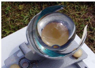
Heliostat – šošovka, ktorá zaznamenáva slnečnosť a oblačnosť počas dňa.
